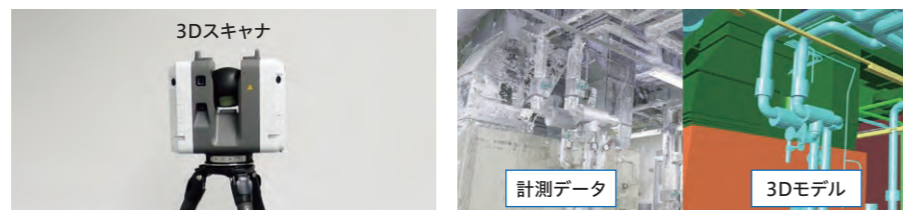
現場の状況をデジタルデータで記録 計測データから3Dモデルの作成も可能
